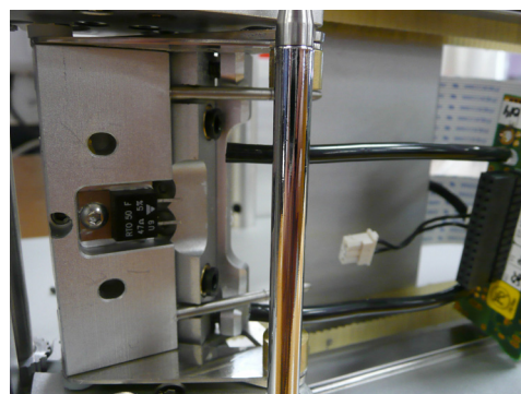
Calefactor y tubos del cabezal de impresión (se muestran desconectados de la impresora)
