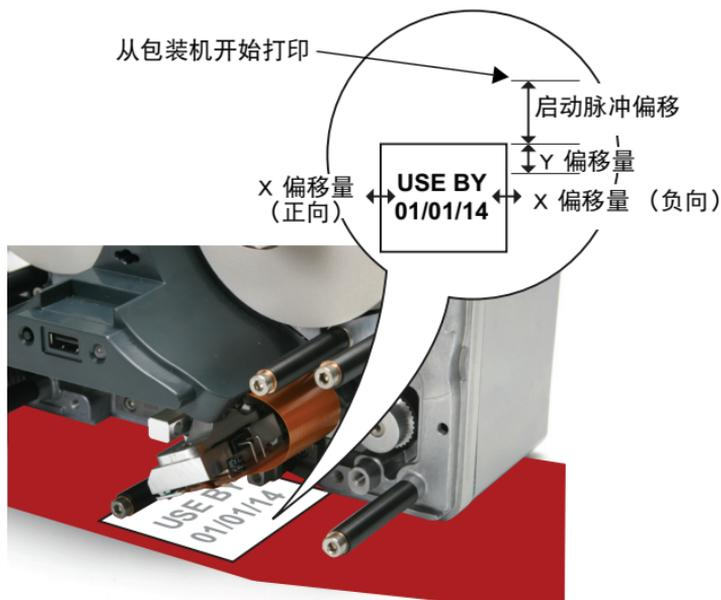
**X 偏移量** - 沿打印头横向移动打印位置 (X 轴)。如果输入负值，打印将朝打码机后部移动；如果输入正值，打印将朝打码机前部移动。
