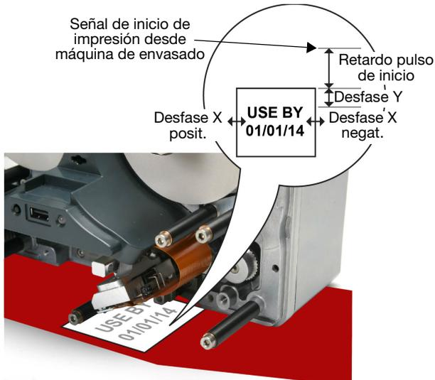
**Desfase X** - Mueve la posición de impresión a lo largo del cabezal de impresión (eje X). Introduciendo un valor negativo, la impresión se desplazará hacia la parte posterior de la impresora. Si se introduce un valor positivo, la impresión se desplazará hacia la parte frontal de la impresora.
